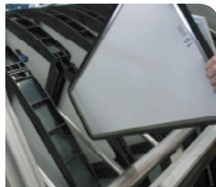
Чтобы снять панели с фильтрующим материалом, сливать воду из ёмкости фильтра не требуется.
